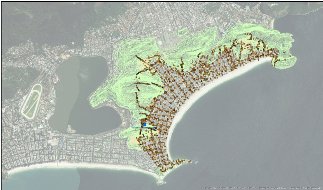
Figura 3- Mapa gerado nos ArcMap 10.4 mostra os dados usados para gerar o MDT, modelo digital de terreno, pontos cotados e curvas de nível originalmente disponíveis em arquivos do Autocad de extensão .dwg
